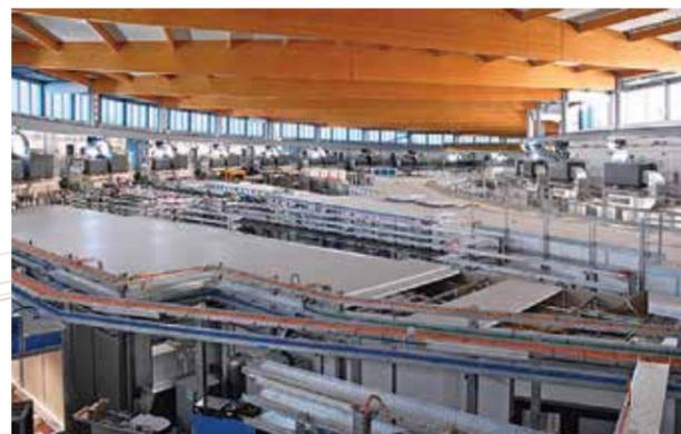
Dans le cadre d'IPANEMA, une nouvelle ligne de lumière (PUMA) dédiée à l'étude des matériaux du patrimoine est implantée au sein du synchrotron SOLEIL. Cet instrument permet d'explorer de façon non-destructive le cœur de la matière grâce au rayonnement produit par la circulation d'électrons à une vitesse proche de celle de la lumière.
